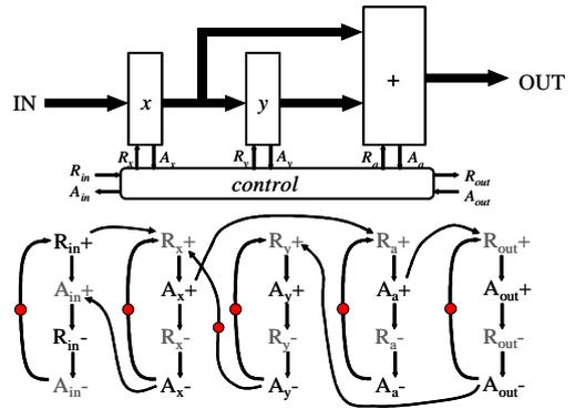
Fig. 11. Bundled-Data Filter Controller
